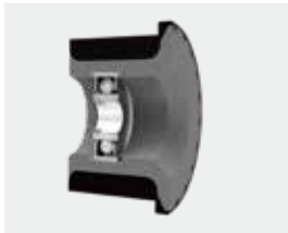
1 轮子采用精密模具复合注塑工艺，内圈采用高强度材质确保强度及寿命，表面采用软质高分子材质降噪音及减震动。
