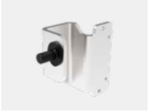
5 链条连接传动结构件采用Q345钢工艺，采用CNC一次加工成型，与连接轴采用高分子轴套连接。
